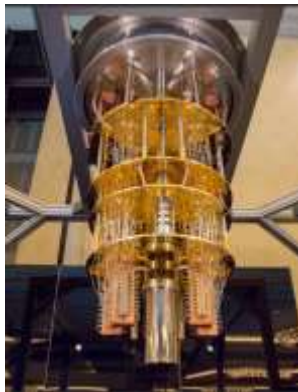
Figuur 3: 50-qubit quantumcomputer IBM 2
